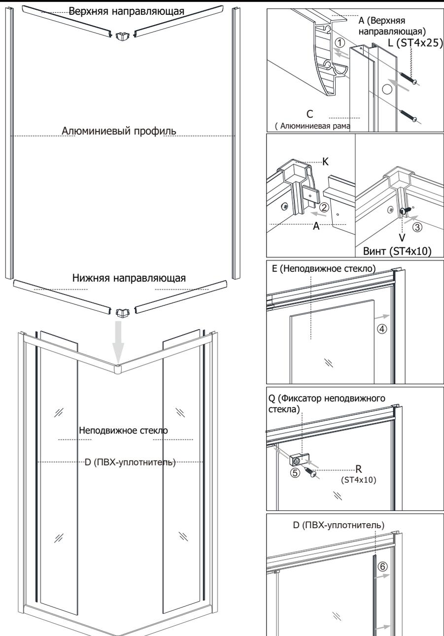
3.1) Пожалуйста, закрепите пластиковый зажим для стекла в направляющий профиль (возможно, он уже закреплен на нем), затем вставьте ПВХ-уплотнитель в неподвижное стекло.
