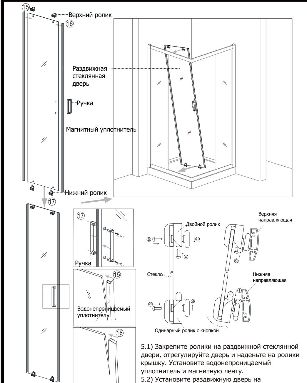
5.1) Закрепите ролики на раздвижной стеклянной двери, отрегулируйте дверь и наденьте на ролики крышку. Установите водонепроницаемый уплотнитель и магнитную ленту.
