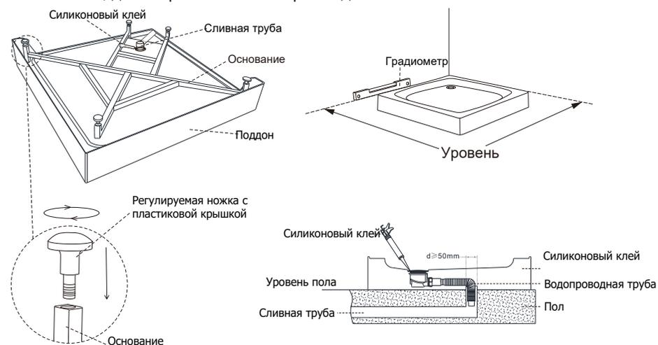
2.2) Проверьте сливное отверстие на предмет утечки воды; если оно пропускает воду, используйте, пожалуйста, силиконовый клей для его герметизации.
