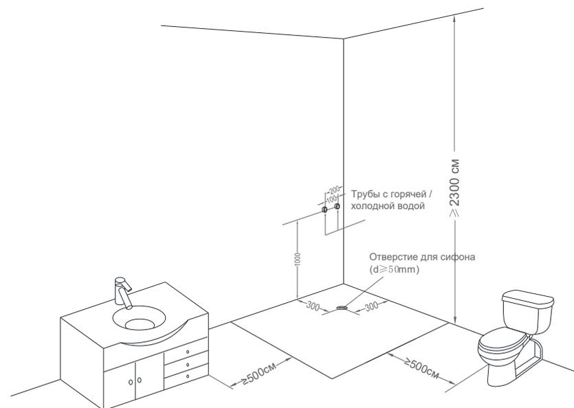
2.1) Сливное отверстие: для надлежащего отвода воды постарайтесь установить сливное отверстие в верхнем положении; если это не представляется возможным, слив должен находиться как минимум на высоте 300 мм, диаметр сливного отверстия должен быть менее 50 мм.
