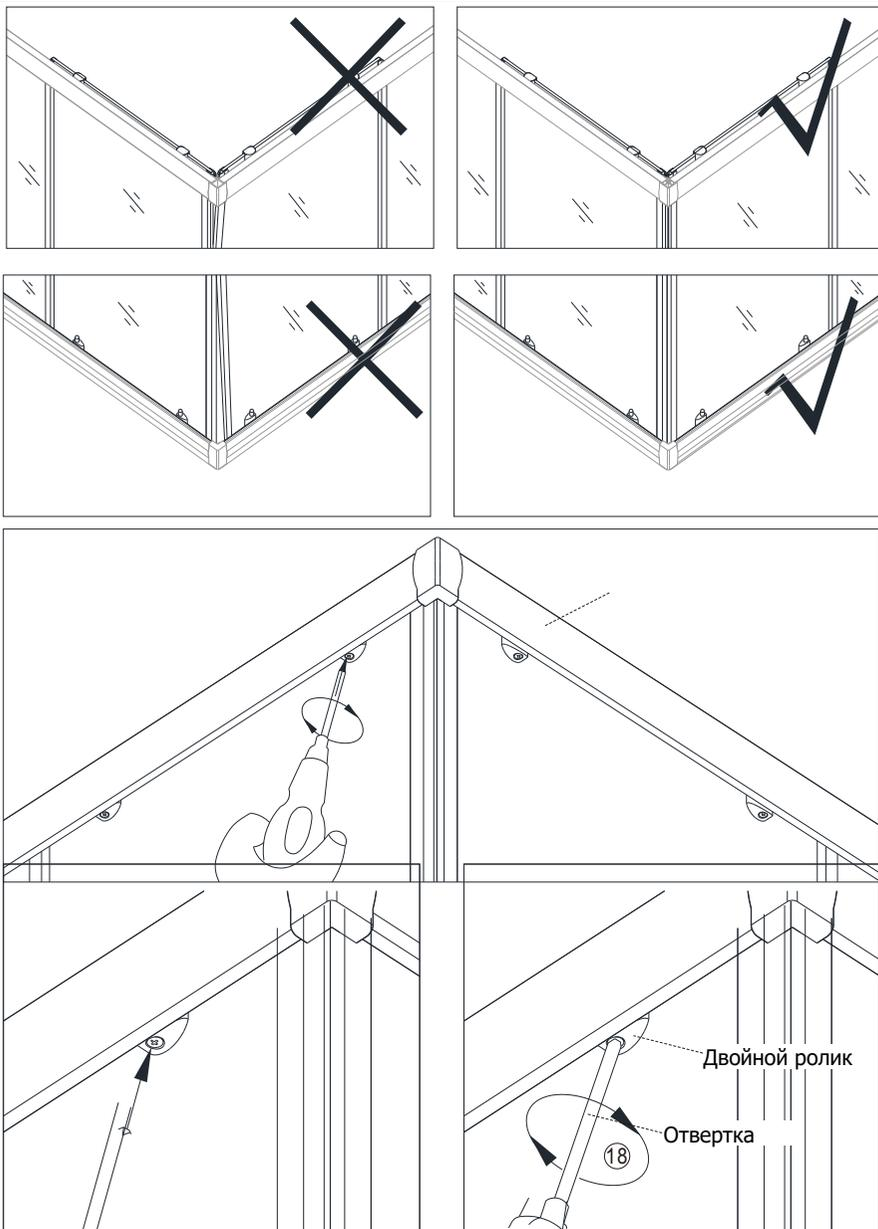
6.1) Пожалуйста, установите ролики раздвижной двери в алюминиевую направляющую. Если середина 2-х раздвижных дверей находится не по вертикали или, если после установки магнитной ленты между 2-я дверьми имеется зазор, следует отрегулировать винт на роликах с помощью отвертки, чтобы 2-е сдвижные двери плотно прилегали друг к другу
