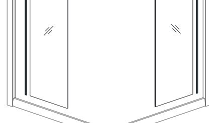
3.1) Пожалуйста, закрепите пластиковый зажим для стекла в направляющий профиль (возможно, он уже закреплен на нем), затем вставьте ПВХ-уплотнитель в неподвижное стекло.
