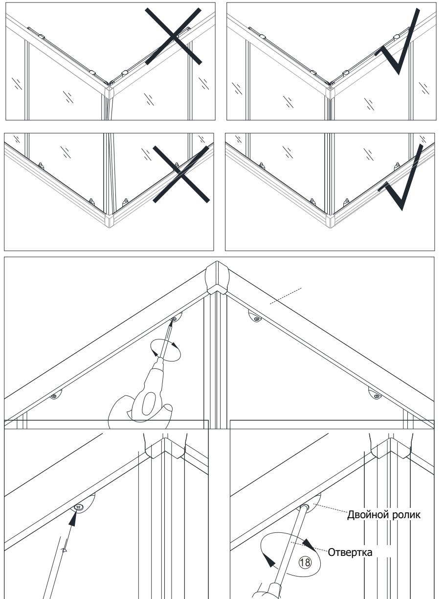
6.1) Пожалуйста, установите ролики раздвижной двери в алюминиевую направляющую. Если середина 2-х раздвижных дверей находится не по вертикали или, если после установки магнитной ленты между 2-я дверьми имеется зазор, следует отрегулировать винт на роликах с помощью отвертки, чтобы 2-е сдвижные двери плотно прилегали друг к другу
