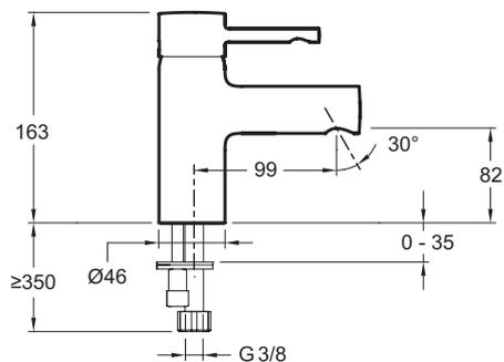
Спецификация продукта: Однорычажный смеситель для раковины без донного клапана. E98298. Коллекция: CUFF. Вес: 1,3 кг. Расход воды: 5 л/мин при давлении 3 бар. Высота под изливом: 163 мм. Механизм: Керамический картридж.
