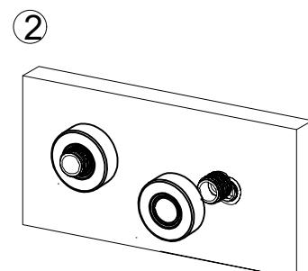
2. Прикрутите настенные отражатели (поз. 4) на эксцентрики (поз. 4).
