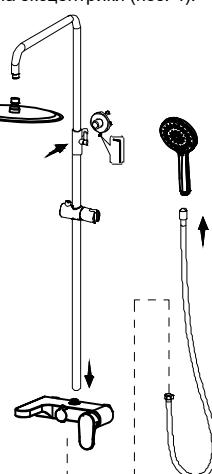
6. Закрепите душевую стойку (поз. 1) на смесителе (поз. 3). Подключите стойку (поз. 1) к держателю (поз. 9). Подключите душевой шланг (поз. 8), лейку (поз. 7) и верхний душ (поз. 2).
