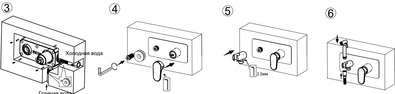
3. Установите встраиваемый корпус (поз. 1) в монтажное отверстие и закрепите его с помощью винтов. Откройте вентили и проверьте систему на герметичность.
