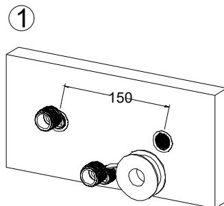
1. Обмотайте лентой резьбовые соединения эксцентриков (поз. 2) и вверните их в водопроводные выходы на стене. Затем затяните гаечным ключом. После этого промойте систему в течение 30–60 секунд, чтобы удалить возможные загрязнения.
