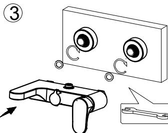
3. Установите резиновые уплотнители на гайки смесителя (поз. 3) и закрепите смеситель на эксцентриках (поз. 4) с помощью гаечного ключа.
