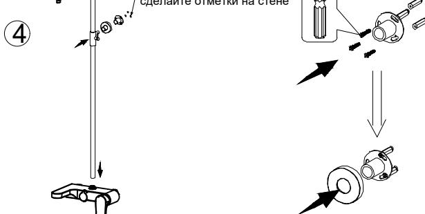
4. Прикрепите душевую стойку (поз. 1) к смесителю (поз. 3). Определите необходимую высоту крепления держателя душевой стойки (поз. 9) и сделайте отметку.
