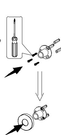
5. Установите держатель (9) с помощью крепежного комплекта. Закройте крепление декоративной накладкой.
