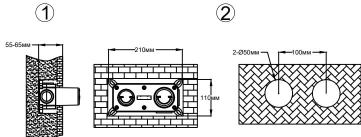
1. Выполните монтажное отверстие глубиной 55–65 мм и размером 210×110 мм. Очистите его от строительной пыли и грязи.
