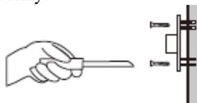
Совместите отверстия пластины с отверстиями в стене и прикрепите пластину к стене.
