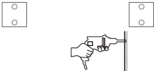
Измерьте расстояние между отверстиями и просверлите отверстия перфоратором.
