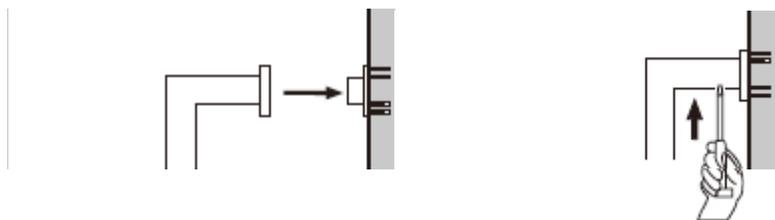
Вставьте корпус в закрепленную несущую пластину торцевым ключом затяните болты с шестигранной головкой.
